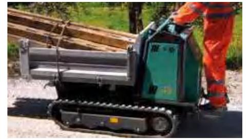
**CARRY 110 B version avec bétonnière sans pelle chargeuse**
