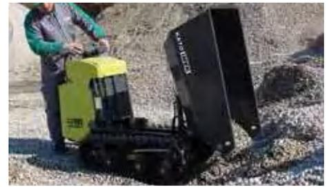
Equipé de 2 pompes hydrauliques qui permettent une utilisation indépendante du déversement et de la translation
