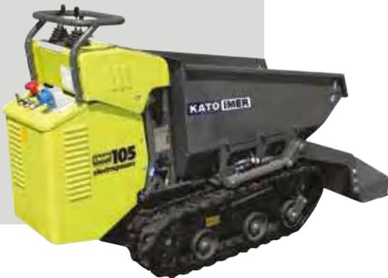
Grâce au châssis, aux roues motrices de grandes dimensions et aux 3 roulements par côté, le CARRY 105 électrique est à l'aise sur tous types de terrains, même sur les pentes difficiles, escaliers et rampes. Avec une capacité de chargement de 0.22 m<sup>3</sup>, il peut graver une pente jusqu'à 20%.
