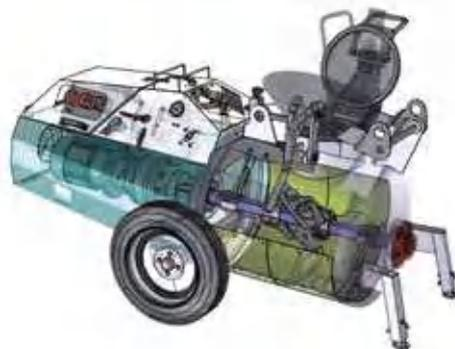
Entretien réduit au minimum grâce à un revêtement interne de la cuve en tôle anti-usure ; composants mécaniques facilement accessibles
