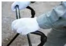
Système anti-vibrations qui réduit de plus de 50% les vibrations transmises dans le bras de l'utilisateur
