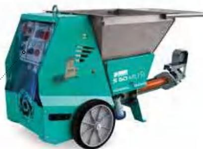
Tableau électrique de commande, simple et intuitif, équipé du nouvel "INVERTER" exclusif "IMER A1" capable de surveiller en continu la pression et de compenser automatiquement à la fois l'usure du stator et les éventuelles différences de fluidité gênantes entre un mélange et l'autre, assurant toujours une pulvérisation homogène maximale.
